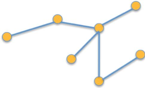
En particulier,  $\omega_{T^*}$  est une borne inférieure de la valeur du tour optimal. En effet, si l'on retire une arête dans un tour optimal (qui est un cycle hamiltonien) on obtient une couverture du graphe. On note  $\omega_{T^*}$  la valeur minimale du poids d'un arbre couvrant.
